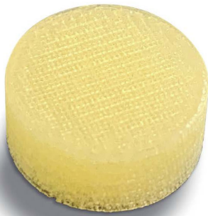
Bild 1. Die Tablette (links) wurde mit dem Freeformer hergestellt. Die elektronenmikroskopische Aufnahme (rechts) zeigt deren gitternetzartige Struktur. © Merck
